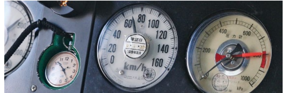
↑ 図 電車の速さの変化 電車のスピードメーター(中央)
