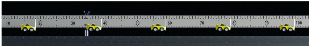
↑等速直線運動をする模型自動車のストロボ写真(発光間隔 0.2 s, 目盛り単位 cm)
